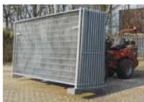
Transportbeholder i genbrugsplast. Vertikal transport af 28 prægalvaniserede hegn.
